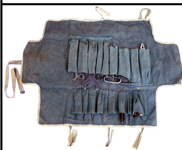
شکل ۹-۲: جعبه ابزار با کیسه‌های برزنتی محتوی آچارهای مختلف
