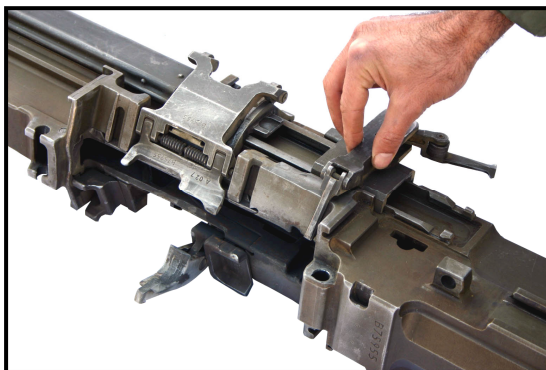
شکل ۴۰-۲: پیاده و سوار کردن دستگاه قطع و وصل آتش
