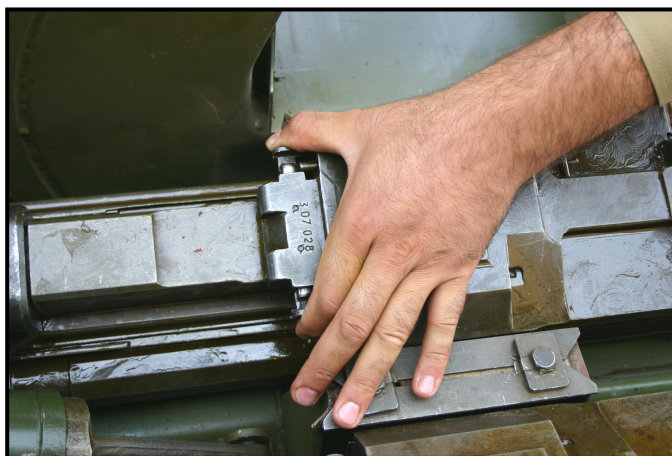
شکل ۱۱-۲: باز کردن درب فوقانی
