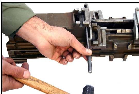
شکل ۴۸-۲: خارج کردن پین انبرک
