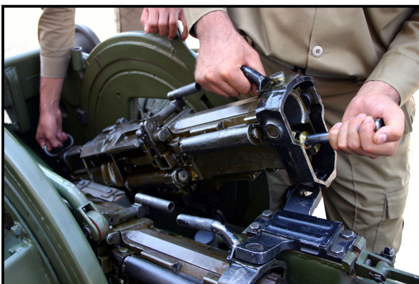
شکل ۱۸-۲: نحوه پیاده کردن متعلقات
