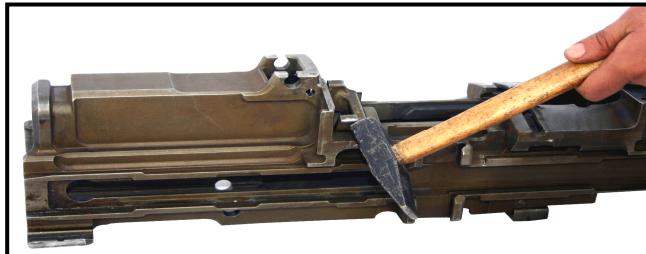
شکل ۵۱-۲: پیاده کردن تکیه‌گاه عقبی فشنگ
