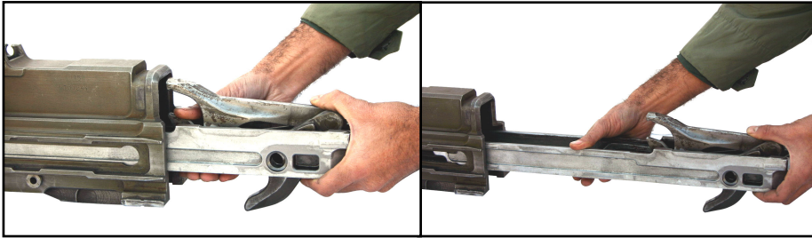
شکل ۳۸-۲: بیرون کشیدن آلات متحرک از جعبه متعلقات
