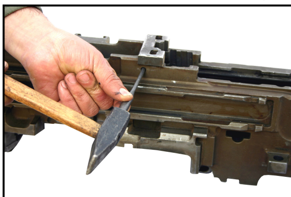
شکل ۴۵-۲: پیاده کردن نگهدارنده کولاس
