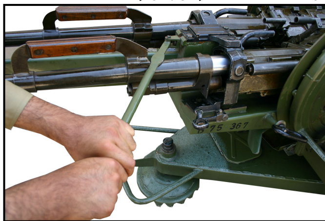
شکل ۱۳-۲: به جلو دادن لوله توسط اهرم درآورنده لوله
