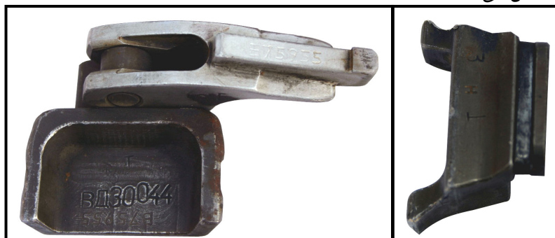
شکل ۷۶-۲: تکیه‌گاه عقبی فشنگ و تکیه‌گاه جلویی فشنگ
