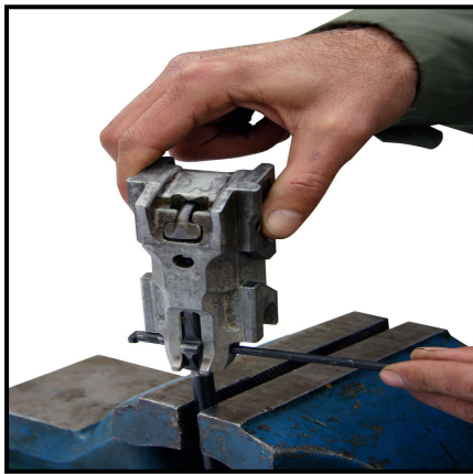
شکل ۶۴-۲: خارج کردن پین میله راهنمای فنر ضارب
