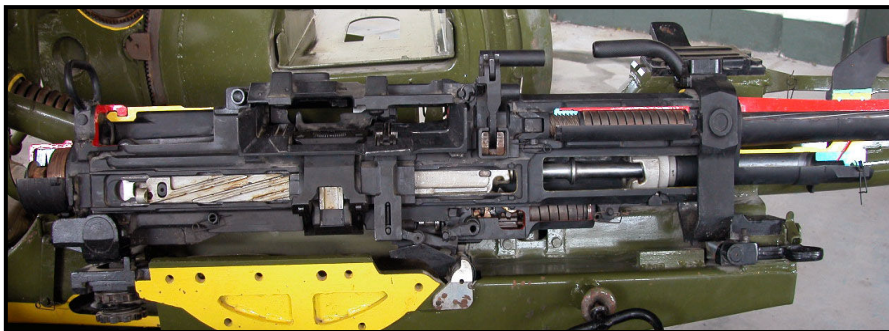
شکل ۳-۳: وضعیت قطعات جعبه متعلقات هنگامی که آلات متحرک در عقب است
