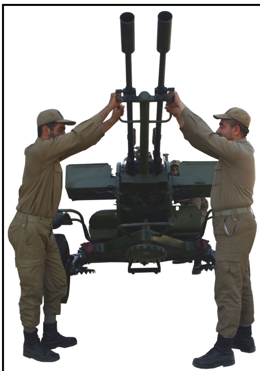
شکل ۳-۴: دادن حرکت نوسانی به گهواره
