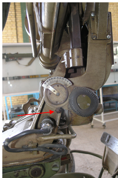
شکل ۵-۷: گریس خورهای آشکار دستگاه نشانه روی
