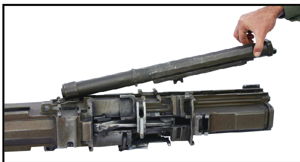
شکل ۲-۳۳: پیاده و سوار کردن عاید
