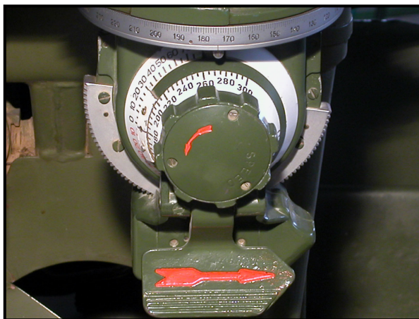
شکل ۲۴-۱: توپی و طوقه مسافت، صفحه مدرج شیرجه و صعود
