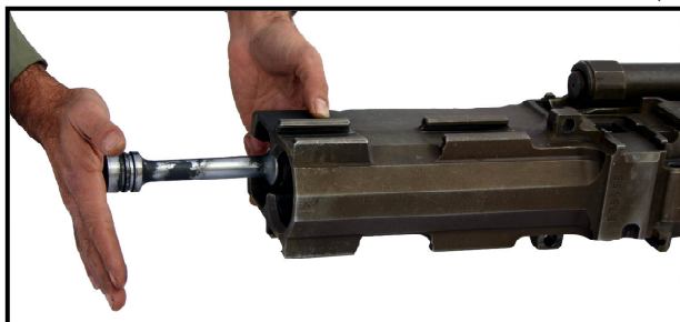
شکل ۲-۳۲: به عقب دادن پیستون برای پیاده کردن عاید
