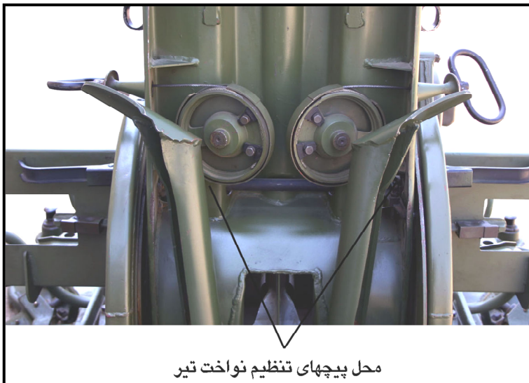
شکل ۲۷-۴: تنظیم نواخت تیر
