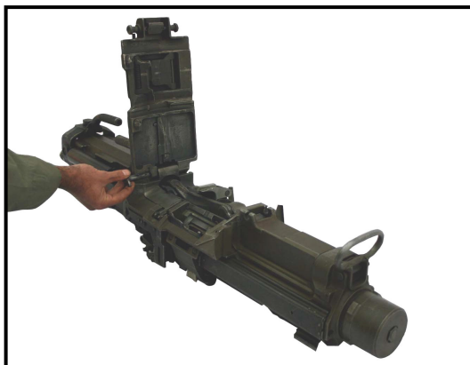
شکل ۲۰-۲: خارج کردن محور درب فوقانی
