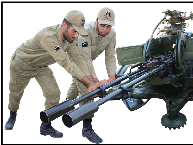
شکل ۷-۵: چرخش لوله‌ها در سمت و قفل کردن در سمت توپ
