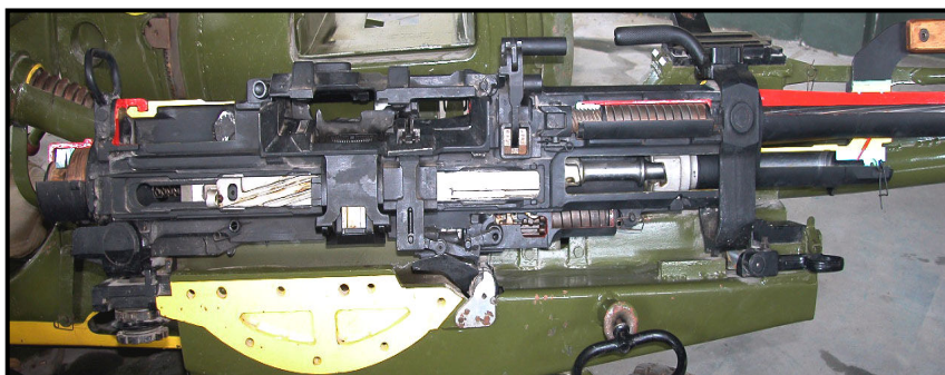
شکل ۲-۳: جعبه متعلقات در حال مسلح شدن
