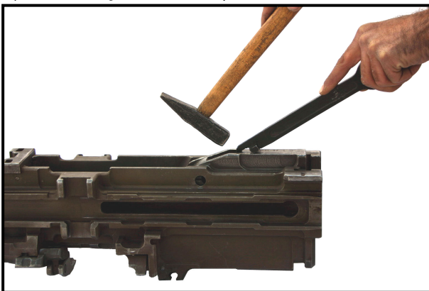
شکل ۳۱-۲: قرار دادن درب عقبه در سر جای خود
