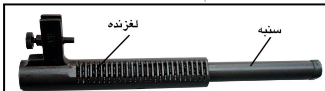
شکل ۹-۴: میله لغزنده در وضعیت خالی کردن نوار
