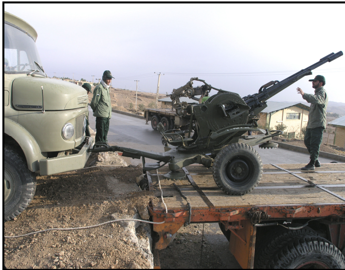
شکل ۱۲-۵: بارگیری و تخلیه توپ ۲۳م.م با خودرو
