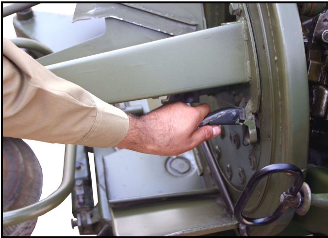
شکل ۲۵-۴: چکاندن دستگیره انفرادی آتش
