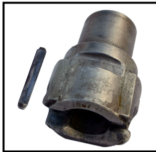
شکل ۷۴-۲: بوش و نگهدارنده موقتی آلات متحرک
