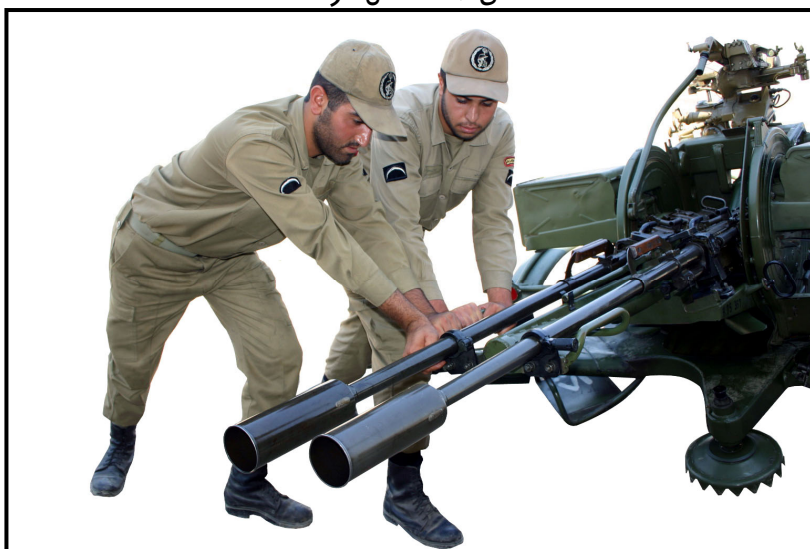
شکل ۶-۴: چرخاندن گهواره تالوله‌ها در امتداد اهرم سه شاخ قرار گرفته و گهواره در سمت، قفل شود.
