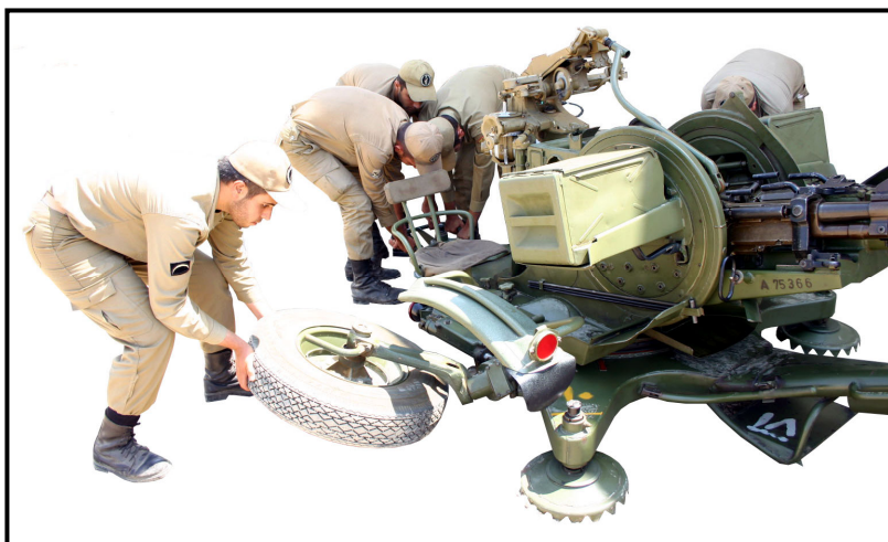
شکل ۵-۴: نحوه قرار گرفتن خدمه برای بلند کردن اهرم سه شاخ، مهمات گذارها چرخ‌ها را به داخل می‌دهند تا قفل شود.
