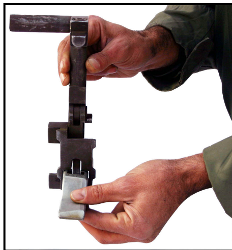
شکل ۲۶-۲: قفل لوله به متعلقات با کفشک مربوط به آن
