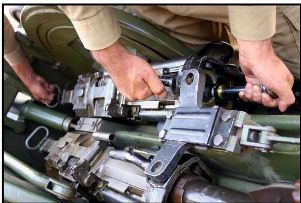
شکل ۱۷-۲: نحوه گرفتن متعلقات برای پیاده کردن آن
