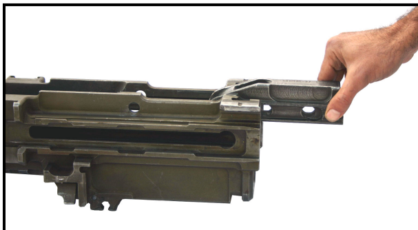
شکل ۴۴-۲: پیاده کردن تکیه‌گاه درب عقبه
