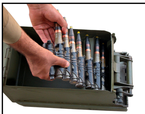
شکل ۲۱-۴: بالا کشیدن نوار فشنگ برای اطمینان از صحت انجام کار
