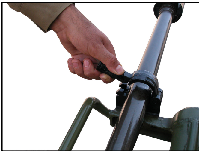
شکل ۱۰-۲: باز کردن قفل لوله به گهواره
