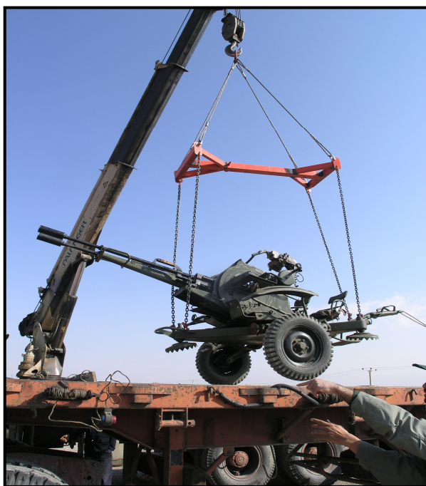
شکل ۱۱-۵: بارگیری توپ ۲۳ م. با جرثقیل
