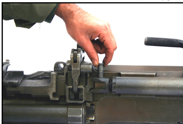
شکل ۲-۲۳: خارج کردن پین‌های دافع‌ها
